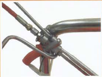
Edelstahl- Schutzrahmen mit Halter für Spritzeinrichtung.
