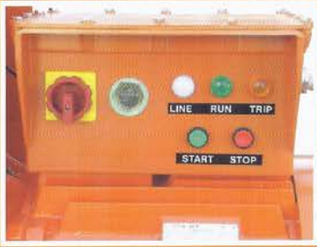
Spritzguß- Schaltkasten mit Hauptschalter/ Schutzschalter & Stundenzähler.
