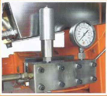
Edelstahl Pumpenkopf mit integrierter Stopfbuchsenkühlung.
